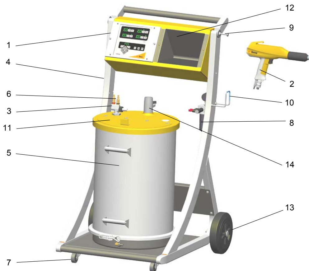
Ручная установка электростатического напыления OptiFlex F - Конструкция
